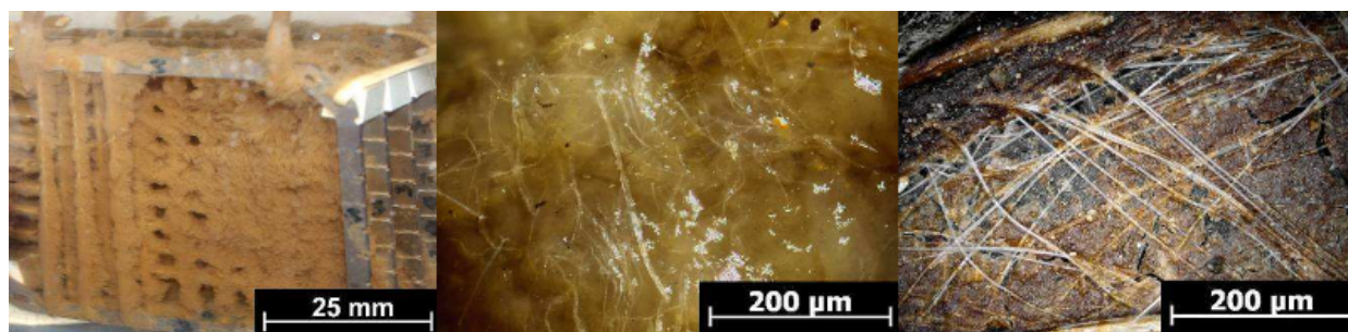
Рис. 3. Біоплівка на фіксованому носії (лабораторний експеримент), деталь біоплівки у вологому і сухому стані (Svobodová & Lederer, 2011)
