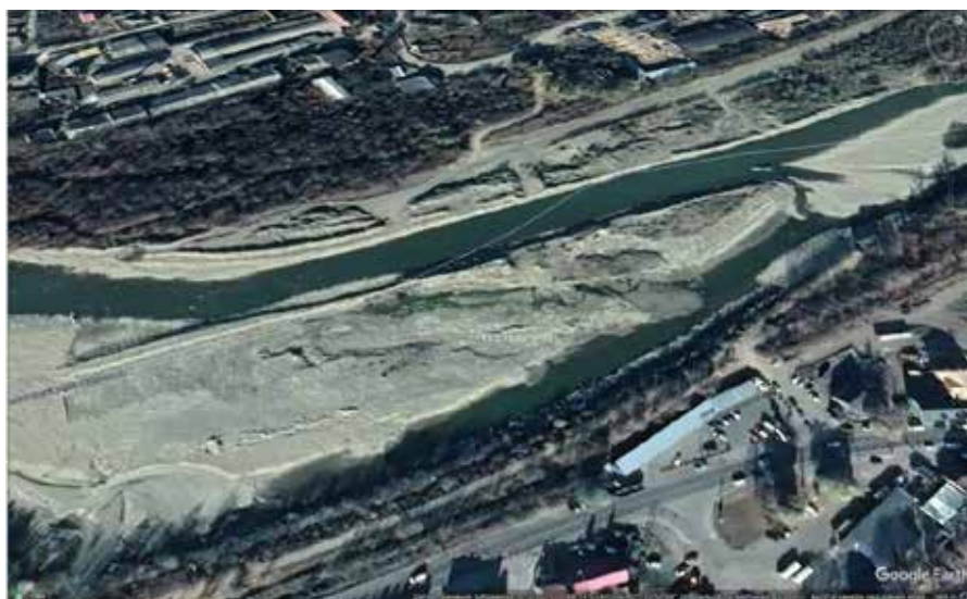
Рис. 7. Відображення частини русла і заплави р. Черемош у межах м. Вижниця станом на 2021 р. (сервіс Google Earth Pro) (Майже повністю антропогенізована ділянка русла. На лівому березі заготовлений для вивозу русловий алювій. Така ділянка не може представляти високу якість МРА)
