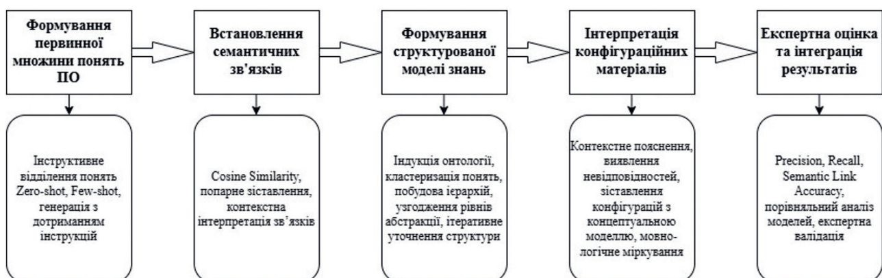
Рис. 1. Структурна схема інформаційної технології автоматизованої концептуалізації предметної області з використанням великих мовних моделей
